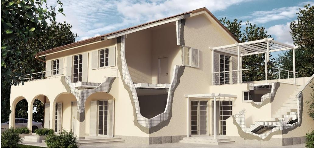
Figura A1. 2. Ejemplo esquemático del SISTEMA GREEN WALLS, unión muro exterior-forjado.
