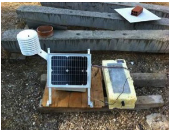
Figura 1 Demostrador piloto de sensores (Indicadores) de corrosión y registro de HR y temperatura ambiental y Resistividad en el jardín del IETcc.
