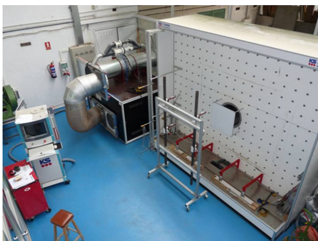
Foto 2. Banco para ensayos de presión y succión
