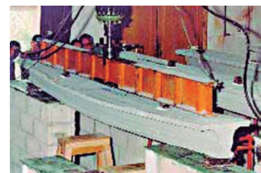
Ensayo de flexión en placa alveolar
