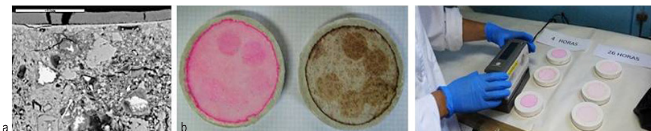
Figura 4. a. Depósito de catalizador en la superficie de hormigón. b. Ensayos de autolimpieza. Muestras tras diferentes tiempos de exposición.
