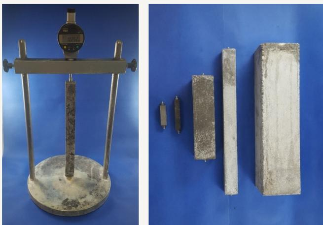
*Distintas geometrías de probetas para ensayos de expansión*
