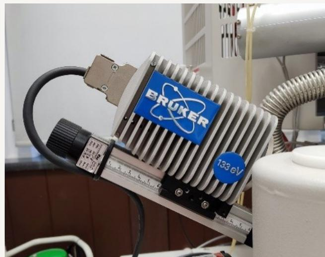
*Detalle del detector elemental de microanálisis*
