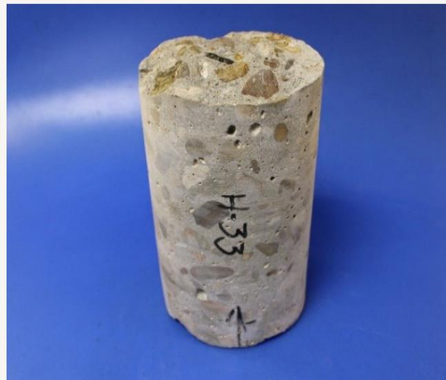
*Testigo de hormigón*
